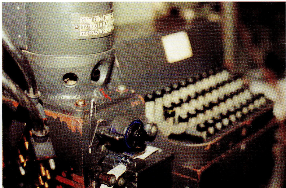
* Detail van het drukgedeelte. Van onder naar boven: Bakje met relais, Papier, Wormas, Inktrol (opgeklapt)
