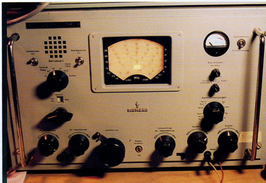
Front Siemens Rx E309
