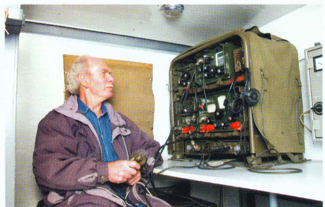
Het hart van de peilwagen is de Sichtfunkpeiler, fabrikaat Platt
