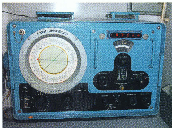
Het hart van de peilwagen is de Sichtfunkpeiler, fabrikaat Platt
