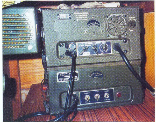
Boven: 100 W lineaire versterker (3 buizen parallel). De transceiver is quartz controlled en heeft 6 kanalen USB/LSB afhankelijk of de oscillator frequency boven of onder de werkfrequency is ingesteld (subtractive of additive mixing). Gebruik van CW is mogelijk.
