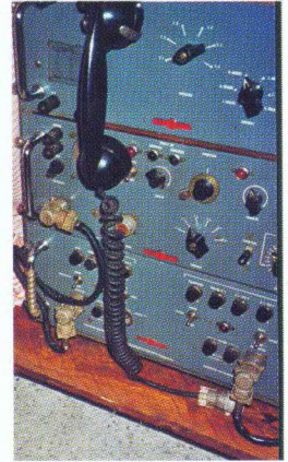
Foto 15. De TR-SM-6-A SSB vast station gebruikt bij de Franse luchtmacht. Onder: De powersupply voor de exciter en versterker. Midden: de THC-881 10W exciter.
