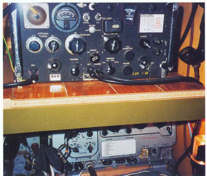
De BC-659-Fr is de laatste ontwikkeling van de BC-620 / BC-659 familie en is in feite een in Frankrijk gebouwde BC-659-J met aangebouwde getransistoriseerde powersupply BA-300 . De set wordt gebruikt met een T-17
