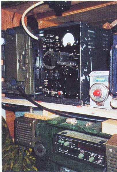
Boven: 100 W lineaire versterker (3 buizen parallel). De transceiver is quartz controlled en heeft 6 kanalen USB/LSB afhankelijk of de oscillator frequency boven of onder de werkfrequency is ingesteld (subtractive of additive mixing). Gebruik van CW is mogelijk.
