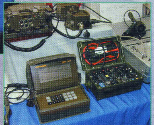
SEM 52 S + dataterminal testset voor Duitse moderne handset
