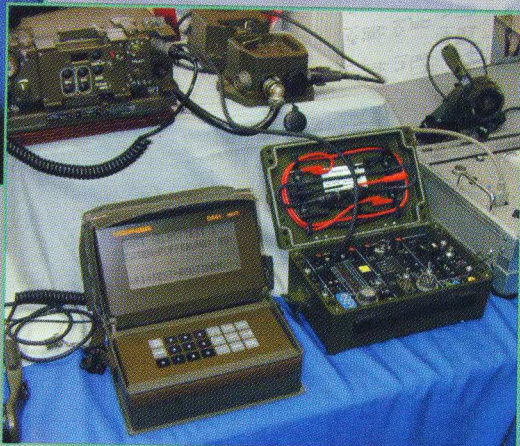
SEM 52 S + dataterminal testset voor Duitse moderne handset
