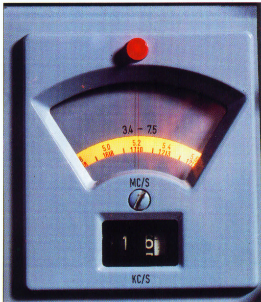
Foto 2 Frequentie- schaal. E 311 a/b. Achter de schroefdop bevindt zich een schaal- lampje.
