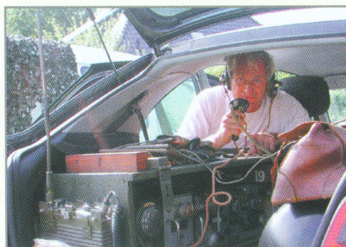
Vanuit zijn auto werkte Jos met een 19-set MK III in originele Italiaanse bekisting.
