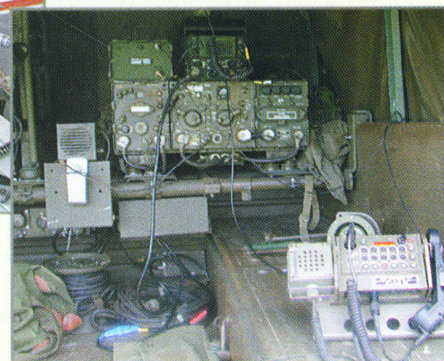
Een RT-600 met eindtrap, in de tent opgesteld (boven) via een uitgerolde remote kabelhaspel naar de DAF YA 126 kon met de RT-600 gewerkt worden. (foto rechts).
