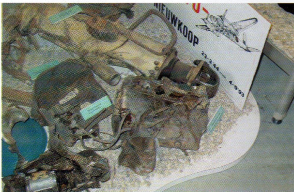
Foto 6: Een ontvanger R3090 uit het wrak van de Mosquito FB VI UP-K HX.823-C die op 24/3/1944 werd vermist en in september 1993 werd geborgen. Weet iemand iets van deze ontvanger?
