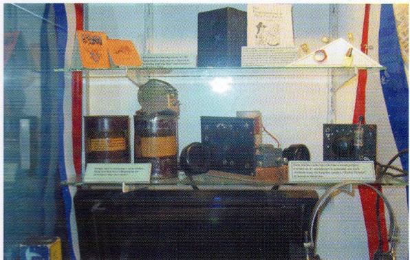
Foto 4: Enkele in de bezettingstijd gemaakte kristalontvangers. De blikjes links bevatten door geallieerde vliegtuigen uitgeworpen radio-onderdelen om deze ontvangerjes te bouwen
