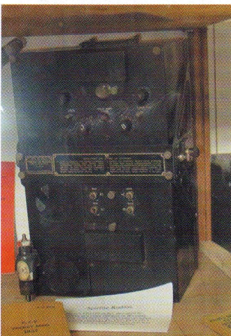
Foto 1: Dit toestel lijkt enigszins op die uit de ARC-5 serie, het is de GF-11 CW/52063A, deze set werd door de vlieger zelf bediend t.b.v. communicatie tussen piloot en verkeersleiding van vliegtuigen onderling. De frequentie is te veranderen door het uitwisselen van spoelen. Links de ontvanger en rechts de zender. In de USA was dit een bekende dumpset, maar is in EU weinig gesignaleerd
