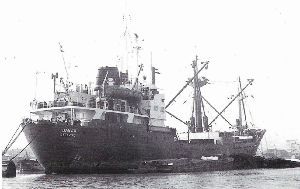
Foto 1. De Barok/pcyf in 1970. Wat direct opvalt, is de 17 meter hoge zendmast bovenop de brug, een echte Marconi-antenne. Direct naast de schoorsteen, achter de brug, bevindt zich de radiohut (aan stuurboordzijde). Samen met het stalen schip en de zee een ideale situatie voor lange afstand HF-radiocommunicatie. Verder zijn een aantal draadantennes te zien.
