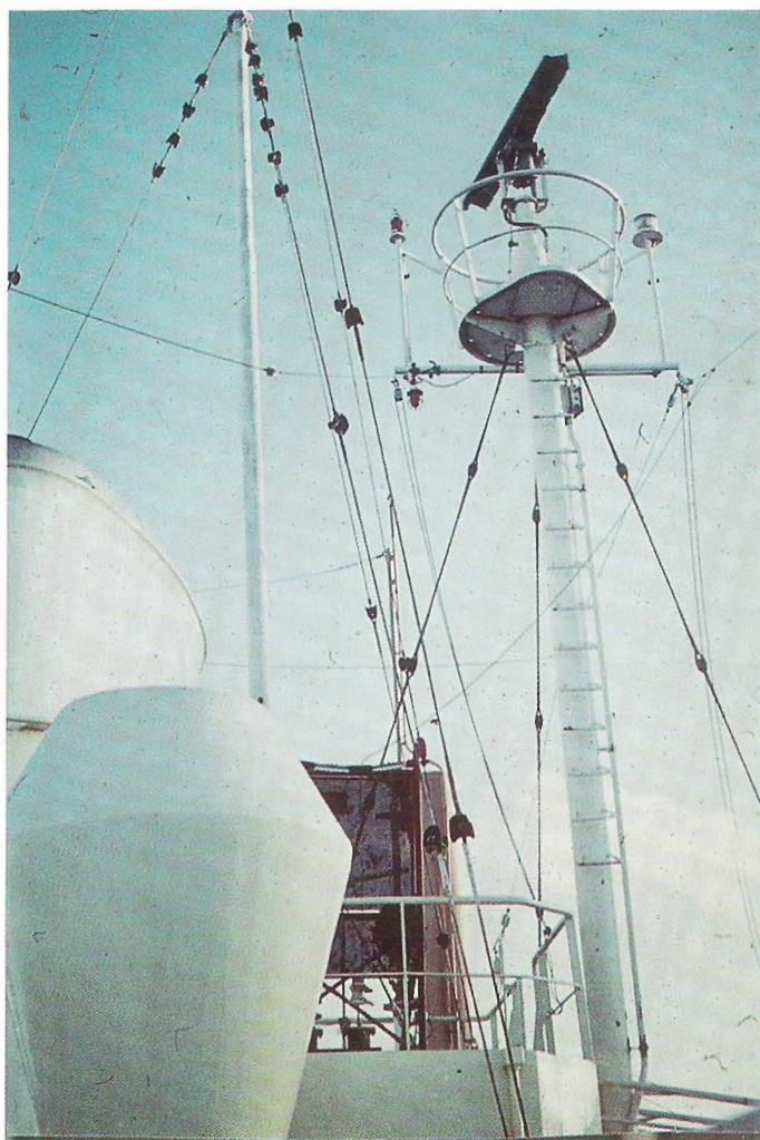
Foto 2. Antennes, minstens zo belangrijk als goede ontvangers en zenders. De tuikabels van de hoofdzendmast zijn voorzien van vele isolatoren. De lengtes die overblijven kunnen niet meeresoneren in de scheepszendbanden in de KG 4-6-8-12-16-22-25 Mhz. Let op de beschadigde doorvoerisolator, door blikseminslag gedeeltelijk weggeslagen. Een nieuwe isolator was in bestelling.
