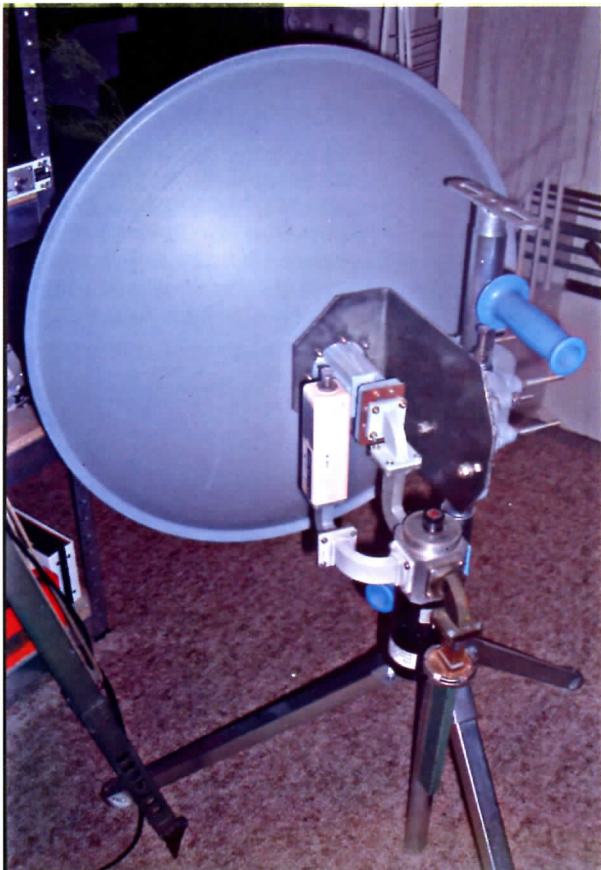
Foto 8: Achterzijde grote 10 GHz-schotel met in het midden de golfpijpschakelaar
