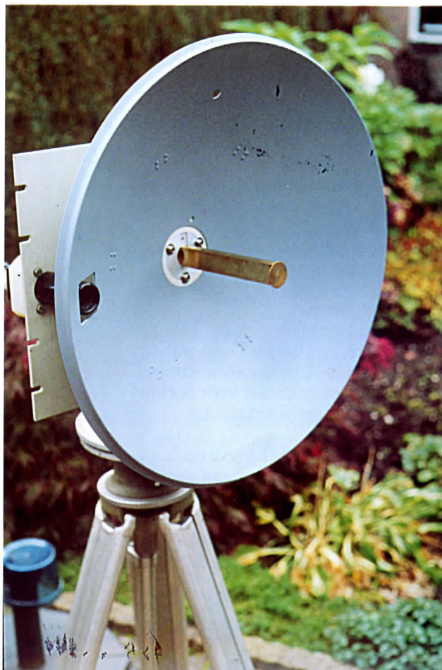
Foto 5: Ook dit is surplus-radio, maar dan wel voor 10 GHz! Een prime-focus schotel uit de radar-installatie van een oud vliegtuig en gemonteerd op een statief waar ooit een landmeters-toestel op stond. De golfpijp met belichter is verstelbaar en kan zo in het brandpunt van de schotel worden geschoven om het optimum te vinden voor de ontvangst en zenden van signalen op deze hoge frequentie
