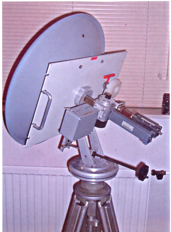
Foto 9: Achterzijde mobiel 10 GHz-station op draaibaar mounting/statief
