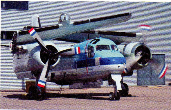
Foto 7 Eén motor van de Tracker draait al, de vleugels zijn nog opgevouwen
