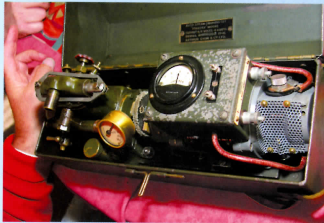
Foto 14 De Alco Steam Charging Set van Mike Willenbroek, helaas niet in de aanbieding. Links de zuigerstoommachine met manometer, rechts de gelijkstroomgenerator met opgebouwde ampèremeter. Er hoort nog een houtgestookte kachel met stoomketel bij. In WOII werd dit apparaat door geheim agenten gebruikt om de 6V accu's voor hun spionagesets op te laden, want vaak was op hun locatie een openbare stroomvoorziening niet of niet meer aanwezig, zeker in het laatste jaar van de oorlog. Met een handgenerator of een op een fietsframe gemonteerde dynamo kon de accu ook worden opgeladen. De ketel die de stoom moest leveren bevond zich in een losse potkachel. De stoommachine maakte wel een behoorlijk geluid en in een woonomgeving was hij eigenlijk niet te gebruiken. Om een standaard 6V accu op te laden moest de machine wel een flink aantal uren lopen, ga maar na, na 1 uur laden was er nog maar 4 Ah aan de accu toegevoegd. Voor een totale lading moest de machine ongeveer 12 uur lopen, in deze tijd moest er ongeveer 3 keer water worden bijgevuld, de ketelinhoud was ongeveer 14 liter.
