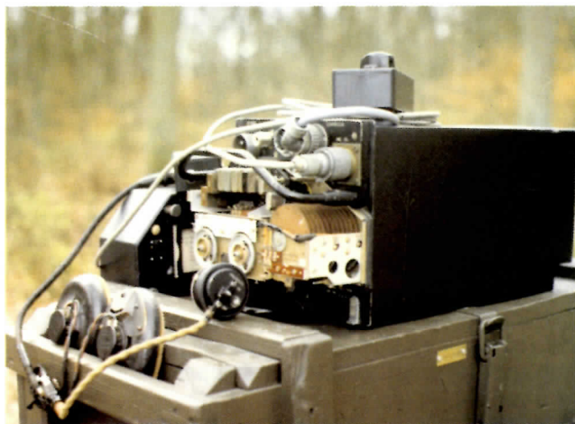
Foto 2: De TR1987 vliegtuigzendontvanger, met mike en hoofdtelefoon. De stofkap is verwijderd, zichtbaar zijn o.a. de kristallen en bovenop een junctionbox
