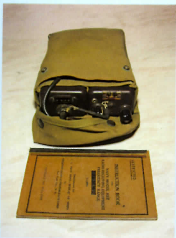
Foto 9 Bart Leijte had een heel bijzonder HF-setje van de US-mariniers in de aanbieding, de RBZ. Deze transceiver is in WOII door de mariniers in de Pacific gebruikt, hier in Europa niet, vandaar dat je ze als surplus weinig tegenkomt
