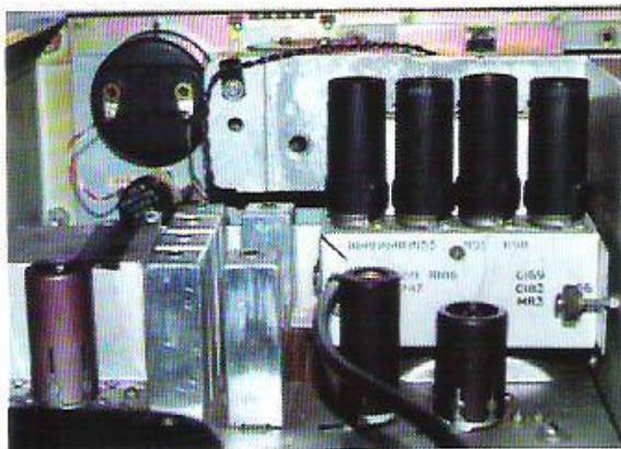
(Foto 8: R-3011A heeft een potmeter onder de meter En vier buisjes voor de 1 MHz oscillator)
