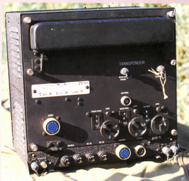
Vliegtuigtransponder RT279/APX Henk van Lochem, PA1PJM
