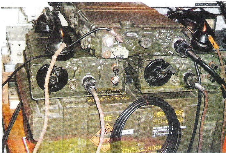
Foto 4 2 stuks Local Control Units C-434/GRC incl. telefoonhoorns met aangesloten PRC-10 radio. Voor de overzichtelijkheid staat de apparatuur hier dicht bij elkaar. Bij operationeel gebruik zal dit uiteraard niet het geval zijn, en kunnen eventueel nog meerdere PRC-radio's deel van dit net uitmaken.
