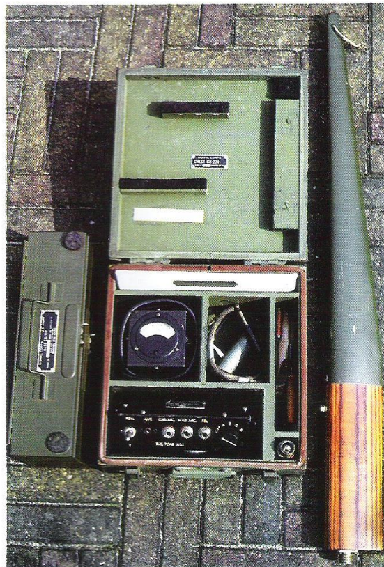
Foto 4 De test-set type IE-36 met veldsterktemeter type I-95, controlunit BC-1303, X-tallenkist en aërodynamische antenne
