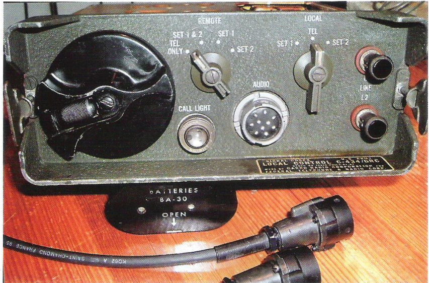
Foto 1: De voorzijde van de Local Control
