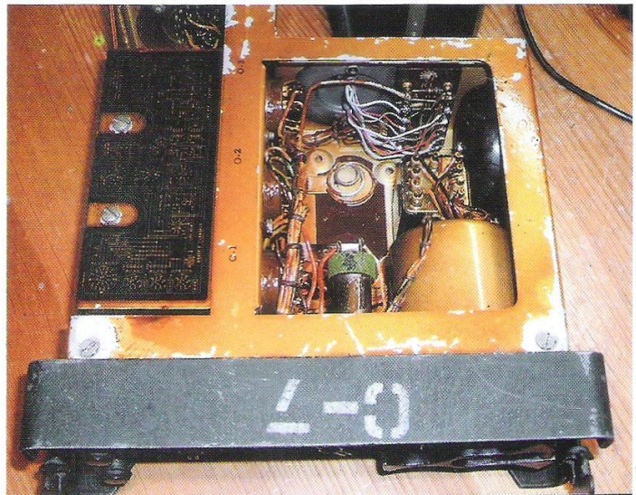
Foto 2: De Local Control C-434/GRC geopend, de batterijbak is tijdelijk gedemonteerd waardoor meer ruimte is verkregen
