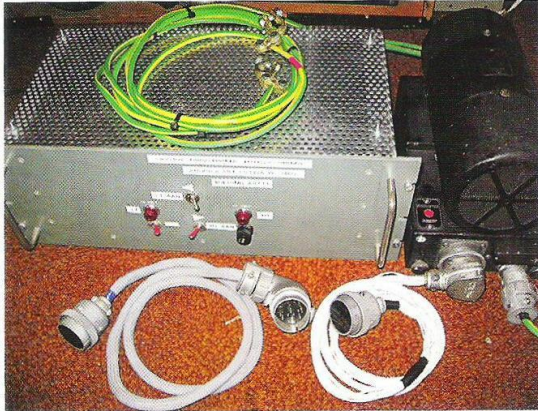
Foto 2—Netvoeding met omvormer DY12/ART13
