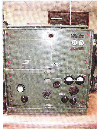
Foto 14 Lo40K39d Fabrikaat: Lorenz 1939 40 Watt kortegolf- zender, alleen tele- grafie, permeabili- teitsafstemming Frequentie: 3,0 – 16,667 MHz in 3 banden Buizen: 3 x RL12P35
