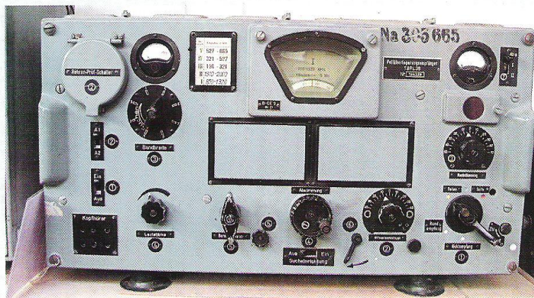
Foto 12 Lo70KL40 Zend/ontvanger uit 1940, 70 Watt Fabrikaat: Lorenz Frequentie: 1,5 – 7,5 MHz in 3 banden Buizen: in zender LS50, ontvanger RV12P2000 De zender is gebaseerd op de vliegtuiginstallatie FuG10, i.p.v. de RL12P35 in de zender is hier de LS50 toegepast
