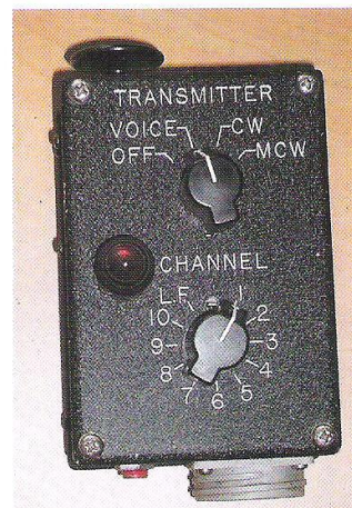
Foto 4 De pilotcontrol, hiermee konden de kanalen 1 t/m 10 worden gekozen
