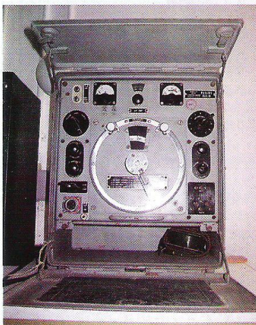
Foto 5 DR 78 (draagbare radio type 78) Fabrikaat: Philips/NSF Frequentie: 3 – 6 MHz Buizen: 6 x D1F, 3 x TC03/5, 1 x 4018D
