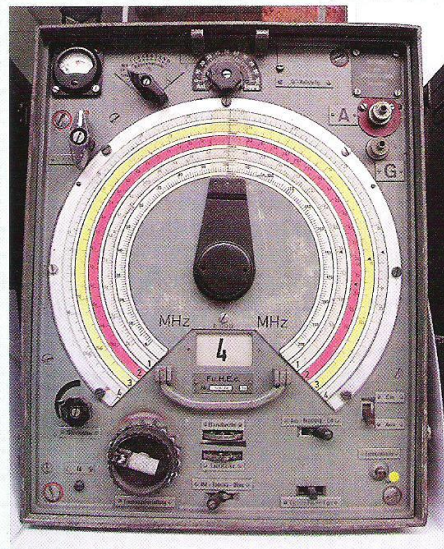
Foto 5 DR 78 (draagbare radio type 78) Fabrikaat: Philips/NSF Frequentie: 3 – 6 MHz Buizen: 6 x D1F, 3 x TC03/5, 1 x 4018D
