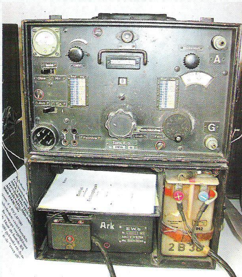
Foto 7 Torn Eb (Tornistor Empfänger type b) Fabrikaat: Telefunken Frequentie: 90 – 7050 kHz in 8 banden Buizen: 4 x RV2P800
