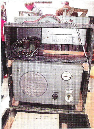
Foto 11 Radione R3 ontvanger Frequentie: 2,5 – 25,7 MHz in 3 banden Fabrikaat: Nicolas Eltz (Wenen) Buizen: 1 x EF13, 1 x ECH11, 1 x EF12, 2 x EDC11, 1 x EDD11, 1 x EZ11 Transportabele ontvanger, zowel netvoeding als accu- voeding met ingebouwde triller. Deze kofferuitvoering is uitermate zeldzaam. Met BFO, hoort bij de Radione- zender RS20. Het kistje met opschrift QUARZE bevat de kristallen die bij de zender horen
