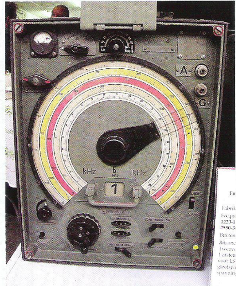
Foto 2 Fu.HE.b (Funkhorchempfänger type b) Fabrikaat: Lorenz (1941) Frequentiebereik: 840 – 3810 kHz in 4 banden Buizen: 11 x RV2P800 IF: 605,5 kHz
