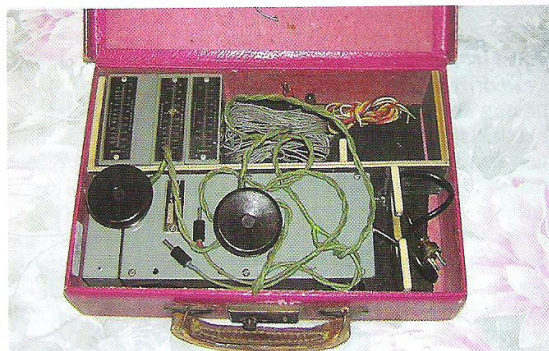
Foto 4 Om de BBC omroep te kunnen beluisteren bij het Verzet werd in België ontvangers van het type SOE MCR-1 gedropt
