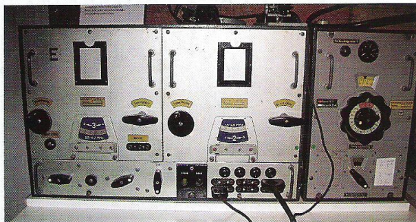
Foto 12 Lo70KL40 Zend/ontvanger uit 1940, 70 Watt Fabrikaat: Lorenz Frequentie: 1,5 – 7,5 MHz in 3 banden Buizen: in zender LS50, ontvanger RV12P2000 De zender is gebaseerd op de vliegtuiginstallatie FuG10, i.p.v. de RL12P35 in de zender is hier de LS50 toegepast
