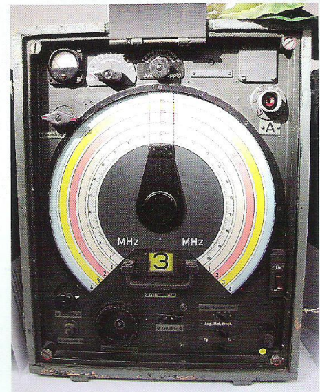
Foto 15 Fu.HE.e (Funkhorchempfänger type e) Fabrikaat: Lorenz Frequentiebereik: 60 – 150 MHz in 4 ban- den Buizen: 13 x RV2,4P700 De kast lijkt niet origineel, maar is op het einde van de oorlog in Tsjecho-Slowakije gefabriceerd. Men had kennelijk geen tijd meer om de afstemschaal individueel te ijkten. Er zal vermoedelijk alleen een ijktable bijge- leverd zijn. De buizen zijn afgenomen in maart 1945.
