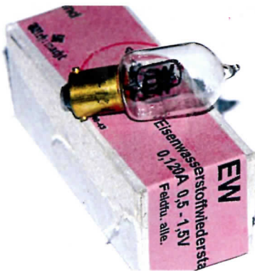
Foto 12 De Eisenwasserstoffwiderstand voor stabilisatie van de spanning voor het draaispoeltje
