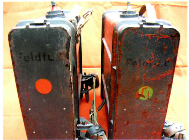
Foto 21 2 Feldfu's met de gekleurde stippen op het achterdeksel om het type aan te geven, dit zijn dus blijkbaar de Feldfu.b (links) en de Feldfu.c (rechts)
