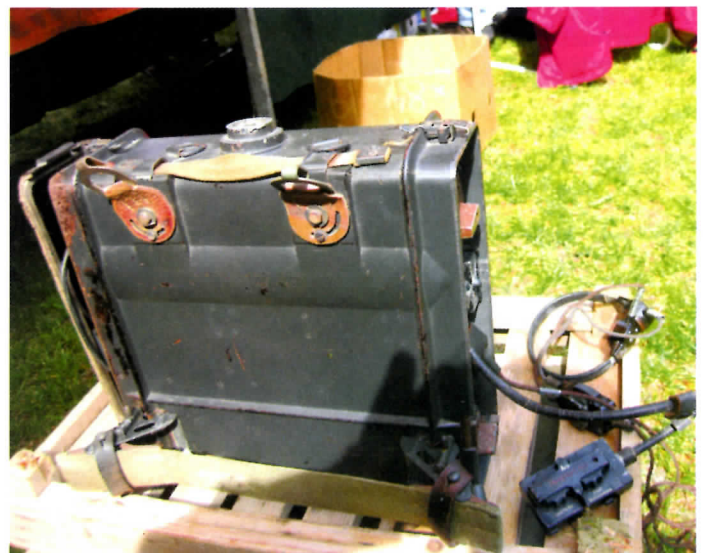
Foto 7 De bevestigingshaken voor het draagstel
