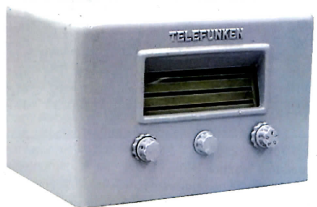
Foto 11 Omroepontvangers aan boord van de duitse U-boote: de Telefunken Ozean-Super met 1 MG- en 2 KG-bereiken.
