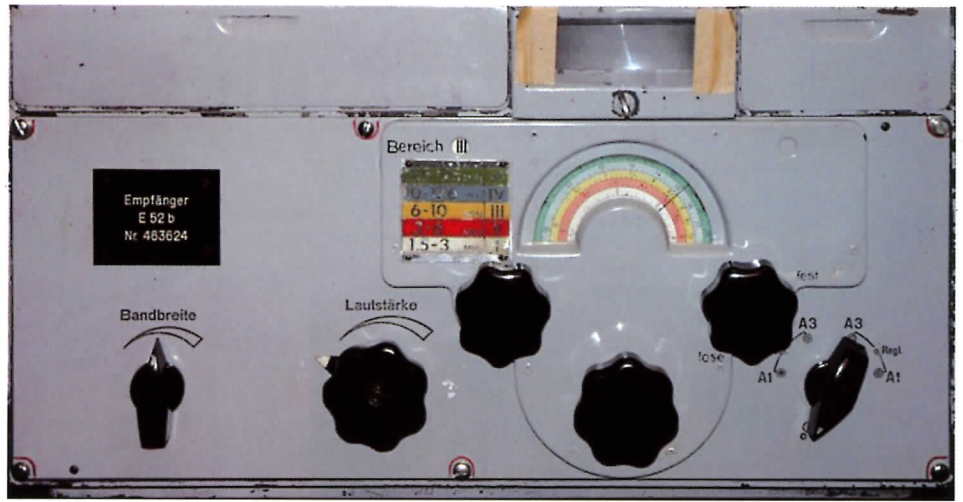
Foto 8 De t.o.v. de E437S veel betere superontvanger E52 Köln van Telefunken kwam pas later in de oorlog in gebruik. Het frequentiebereik was van 1,5 - 25 MHz in 5 deelbereiken, de bandbreedte was continue regelbaar van 200 - 5000 Hz
