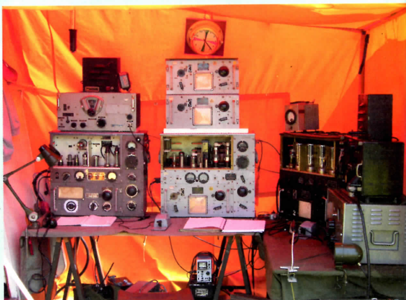
En dan de opstelling van Cor, het lijken drie dezelfde zenders die hij heeft opgesteld maar niets is minder waar, de meest rechtse is de BC-191 en de andere twee zijn gemodificeerd door ik dacht Radio Holland maar zeker weet ik dat niet. Zij zien er bij nadere beschouwing dan ook heel anders uit.
