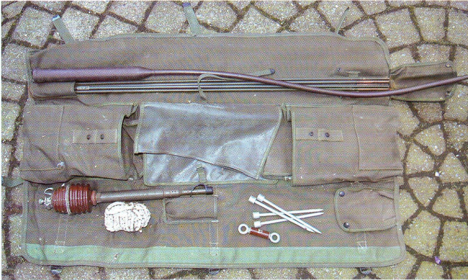
Foto 14: De foudraal met de bekende whip-antenne. In de tas horen ook nog de Reservebuizenset, reservefilters en nog wat klein spul.
