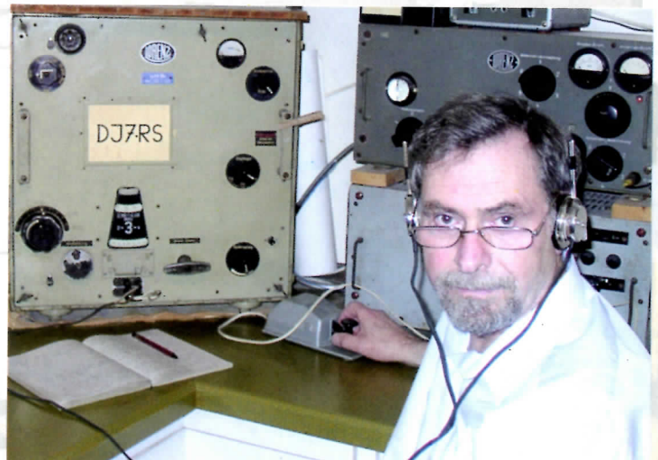
Foto 09 Ook Matthias nu met Lorenz scheepsontvanger Lo 6 K 39a en Lorenz CW-zender Lo 40 K 39
