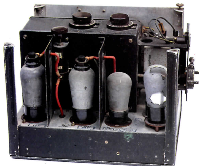
Foto 2 De ontvanger van de TR9, rechtsboven het compartiment voor de negatieve roosterspanningsbatterij met de gelabelde aansluitdraden met stekkers
