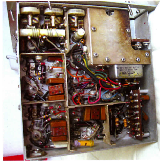
Foto 4, De linkerkant van de MBF, tegen het ontvangerdeelte aangekeken, de trimmers zijn duidelijk zichtbaar. In de verzilverde doos bevindt zich de oscillator.
