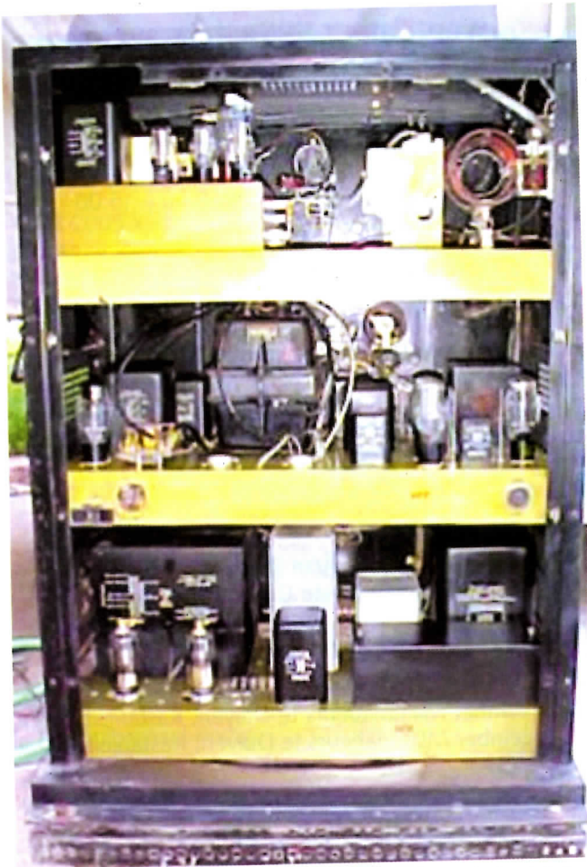
Van boven naar onder: het RF-deck, vervolgens het modulator-deck en tot slot het powersupply-deck
