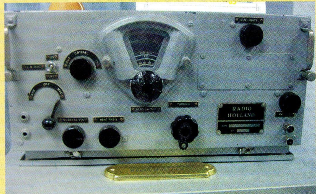
Foto 4: Deze kennen we! De ontvanger BC-348. Door de schaarste aan communicatieapparatuur kort na de oorlog werd er veel apparatuur uit oorlogsvoorraden (surplus dus!) opgekocht. Radio Holland modificeerde deze ontvangers voor gebruik als ontvanger aan boord van Nederlandse koopvaardij schepen waar ze jaren hebben dienstgedaan
