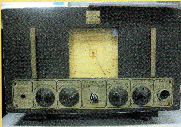
Foto 3: N.V. Nautic type S49-50 serie 24. Scheepsontvanger, bouwjaar 1946, geheel opgebouwd uit surplusmaterialen. MW, LW en visserijband, met BFO en aansluiting voor raamantenne
