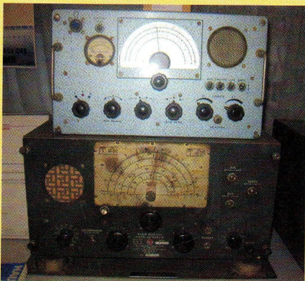
Foto 9: De onderste ontvanger is een Receiver model AR-8506-b van RCA, frequentiebereik 25 kc/s – 25 Mc/s in 5 banden
