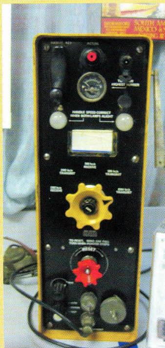
Foto 6: Marconi reddingbootzend/ontvanger type Survivor, bouwjaar 1970. Heeft automatische S.O.S. functie voor de noodfreq. 2182, 500 en 8364 kc/s. Met handgenerator en ingebouwde seinsleutel.
