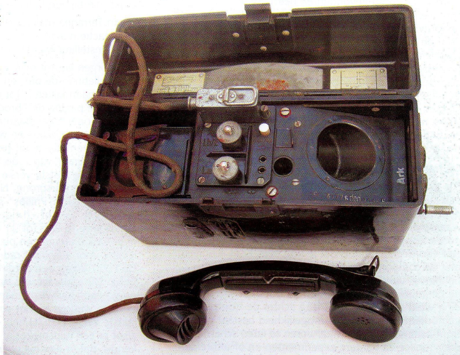
Foto 1 Het veldtelefoon toestel FF33, in het midden de beide lijnklemmen en de witte testknop van de eigen bel
