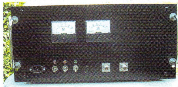
Foto 8 De frontplaat met de bedieningsorganen en in- en uitgang d.m.v. "N"-connectoren
