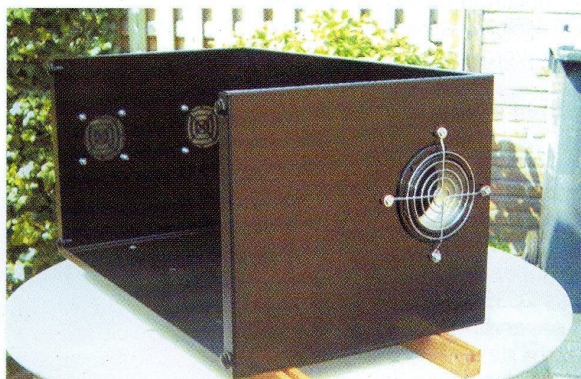
Foto 1 In de nog lege kast zijn openingen gemaakt voor aanzuiging en afvoer van lucht
