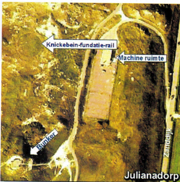
Foto 1 Luchtfoto van de restanten van de opstelling bij Julianadorp, de fundatie van de ring waarop de antenne draaide is nog zichtbaar
