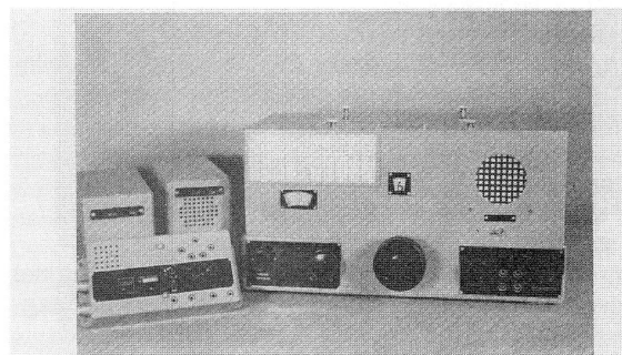
De cascade-ontvanger, type H2L7U, in gebruik als noodontvanger. Links van het toestel zijn het antenne-aanpassingskastje en het omvormerkastje afgebeeld. Deze ontvanger komt ook voor op de foto tegenover het binnensteblad.
