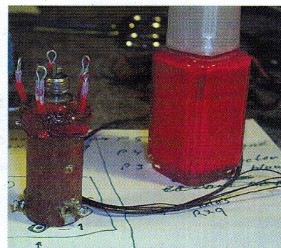
Foto 3 Het garen afgewerkt met nagellak wordt een stevig geheel.
