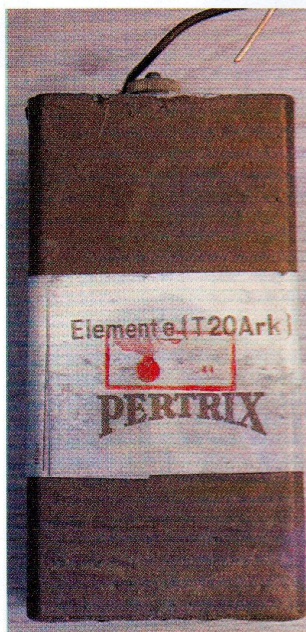
Foto 9 De originele batterijcel met datum van inbedrijfname
