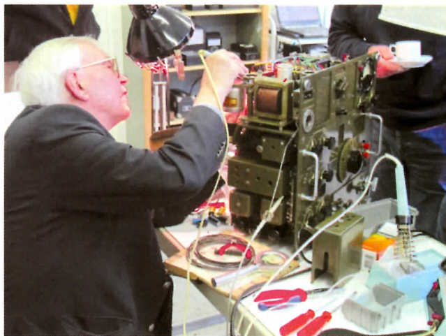
Foto 2. Reparatie van een Autophon E-39 ontvanger
