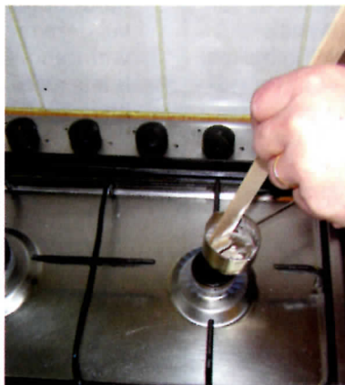
Foto 6. Het verwijderen van de op het gesmolten tin drijvende oxidelaag
