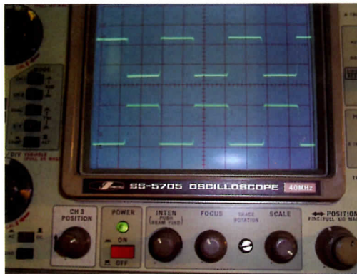
Foto 8. Op de scope is mooi te zien dat de torren netjes in verzadiging gaan, wat een strakke blokvorm oplevert. Dit plaatje is gemaakt bij bijna vollast, n.l. 550 Volt / 100 mA, en gemeten direct op de trafoaansluiting.
