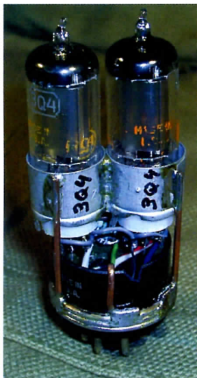
Foto 9 en 10: Een nagmaakte dubbelpentode, ter vervanging van de ARP37
