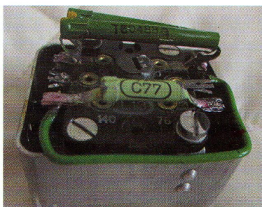
Foto 23: De MF-spoel met de kapotte ijzerkern. Omdat alles is geschroefd laat alles zich gemakkelijk demonteren
