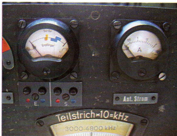
Foto 2: Close-up van de beide meetinstrumenten op het front. De rode druktoetsen zijn voor de gloeispanningen van ontvanger en zender, de blauwe voor de anodespanningen. Voor de juiste grootte van deze spanningen moet de meter uitslaan tot in de gekleurde vakjes
