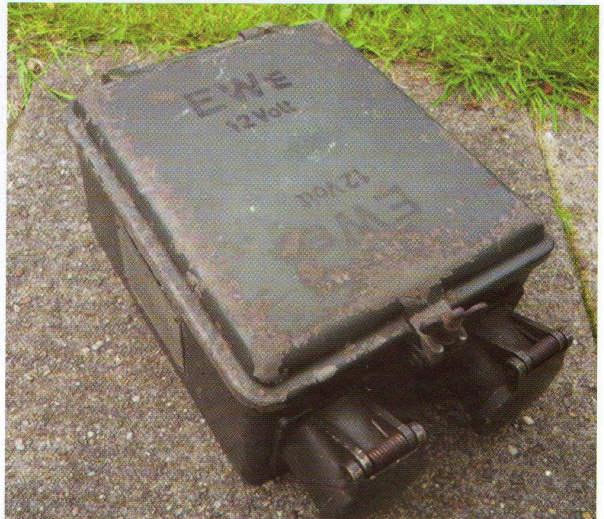
Foto 8: De Wechselrichtersatz EW.e, deze maakt van de 12 Volt voertuigvoeding de 100 en 2,4 Volt
