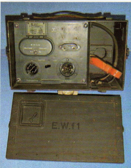
Foto 12: De Wechselerichtersatz E.W.f1 met afgenomen deksel. Deze levert de 100 en 2,4 Volt voor de ontvanger, in het compartiment rechts hoort de 2,4 Volt accu waarmee de E.W.f1 wordt gevoed.
