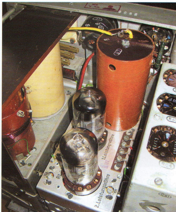
Foto 14: De beide parallel geschakelde eindbuizen, links daarvan de anodespoel met de beweegbare uitkoppelspoel. In de witte cilinder daarboven bevindt zich het z/o-relais
