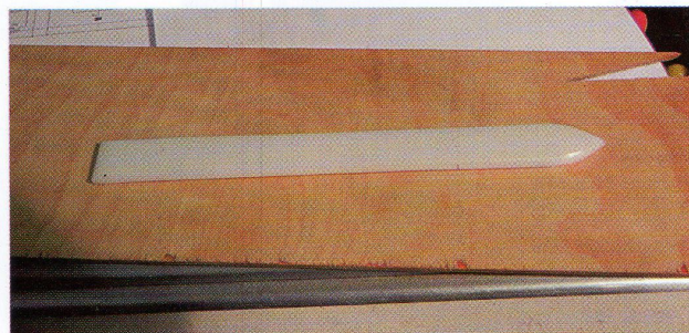
Foto 1: Plaatje lexan van ongeveer 4mm dik, en niet te breed, anders kan ie niet meer door de kern
