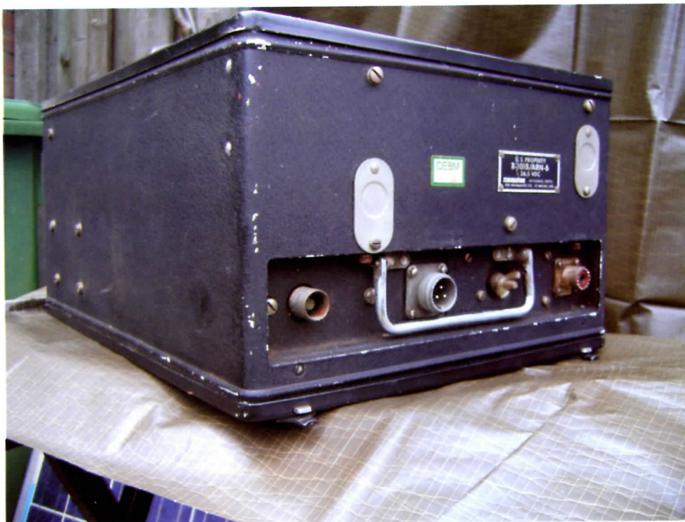
Foto 1. De ontvanger R-101 van de radiokompasinstallatie AN/ARN-6.
