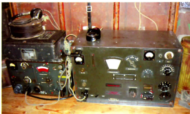
Foto 7. De Fu 12 installatie bestaande uit de 80 W.S.a en M.w.E.c, de omvormer van de ontvanger staat er bovenop (foto van collectie Arthur Bauer).
