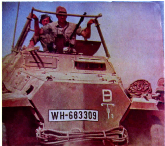
Foto 2. De dakantenne met de isolatoren is goed zichtbaar bij deze gepantserde verkenningswagen. (De foto is uit het Duitse tijdschrift Signaal van sept. 1942 en is genomen in Afrika).
