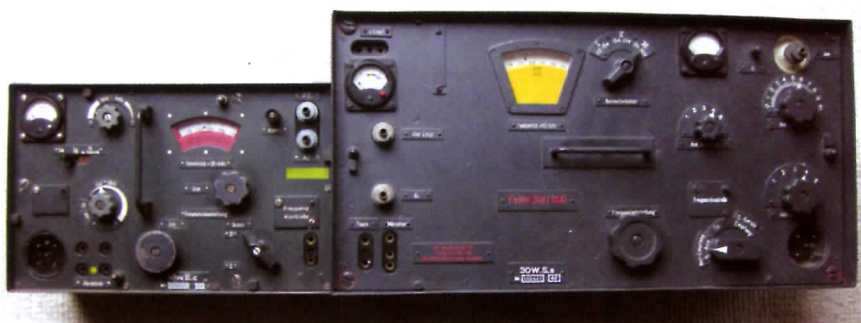
Foto 6. De installatie Fu 8, bestaande uit de ontvanger M.W.E.c en de 30 W.S.a.
