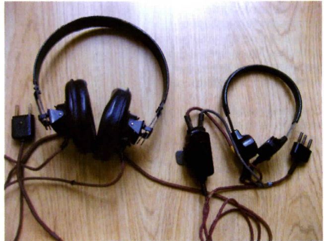
Foto 5. De koptelefoon Dfb.b en Kehlkopfmikrofon voor gebruik in voertuigen.
