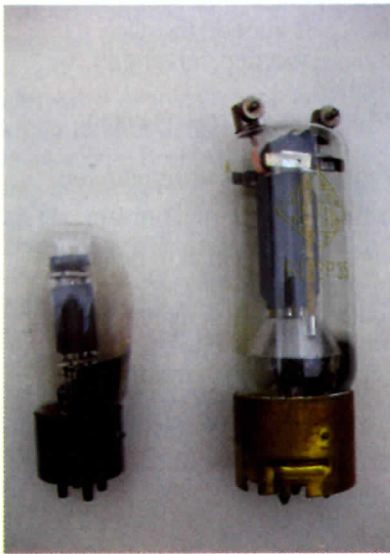
Foto 1. Links de triode RL12T15 en rechts de pentode RL12P35, de werkpaarden in de oscillator en PA van menige MF/HF/VHF-zender van de Wehrmacht.
