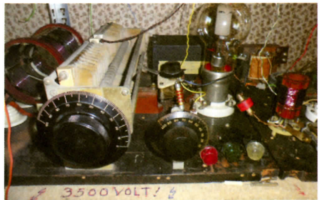
Foto 8: De eindtrap van de 250 TH met grote splitstator
