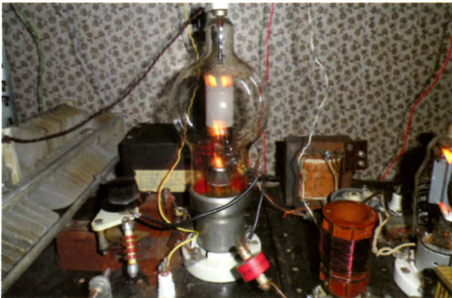
Foto 6: De 250 TH eindlamp met neotrodynamiccondensator en grote splitstator (BC-610).
