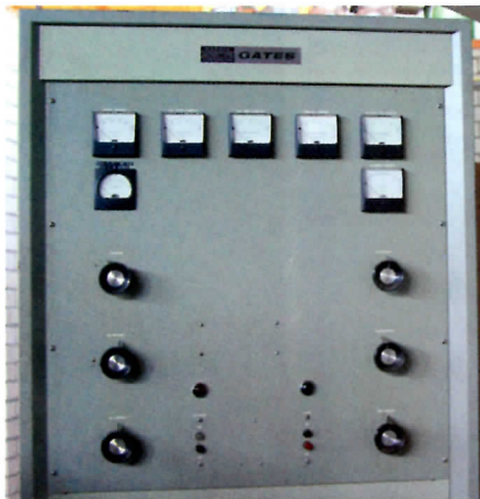
Foto2: De meetinstrumenten en de bedieningsorganen op het front
