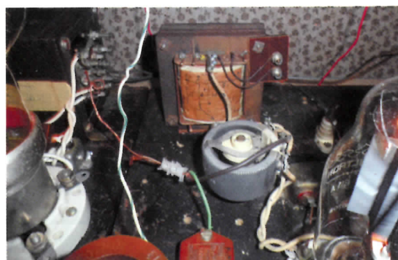
Foto 4: De gloeistroomtrafo en antibrom potmeter voor de 6L6.
