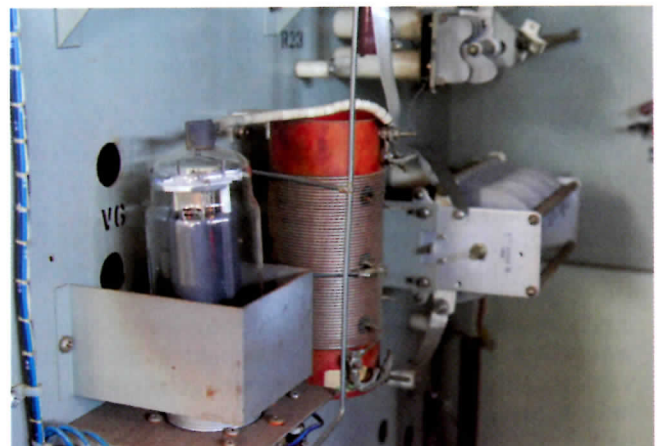
Foto 6: De 813 driver met de neutrodynisatie-condensator.
