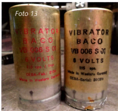
Foto 13: Op de behuizing van deze vibratoren staat een typeaanduiding die niet overeenkomt met de tekst van de vibrator op foto 14, ook het aantal pennen van deze twee zijn verschillend. Ze zijn bedoeld voor 6 Volt maar of dit type in de DY88 thuishoort is mij nog niet duidelijk.
