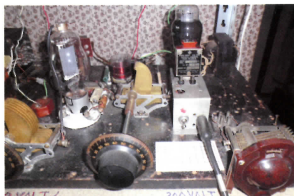
Foto 3: De 6L6 xtal-oscillator, de 811A freq. Verdubbelaar met anodekring en pilot varco uit 1923.
