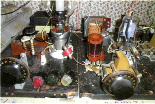
Foto 5: De anodekring van de 811A.
