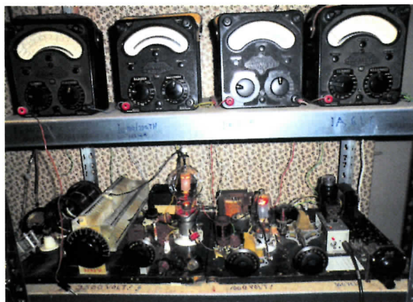
Foto 2: De CW-zelfbouwzender van PAØGWS bij avond en stand by met daarboven 4 AVO-meters v.l.n.r. voor de anodestroom van de 250 TH PA, de roosterstroom van de 250 TH, de anodestroom van de frequentieverdubbelaar 811A en geheel rechts de anodestroom van de oscillator-buis (6L6).
