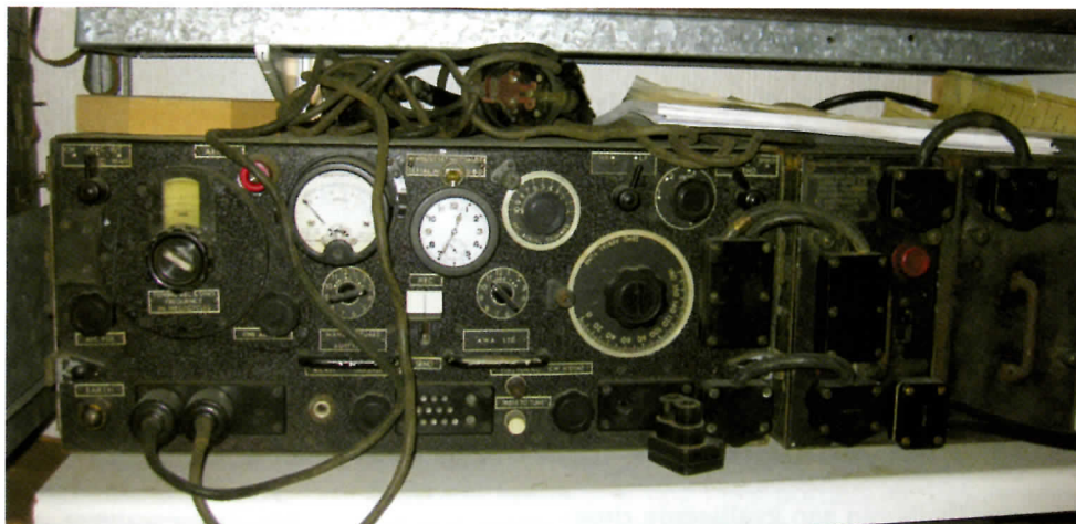
Foto 1: De WS11, aan de rechterzijde van de set de beide omvormers voor hoog- en laagvermogen. Dit is een Australische WS11, die uiterlijk praktisch hetzelfde is als de Engelse uitvoering, maar een andere buizenbezetting heeft. Collectie Nico van Dongen.
