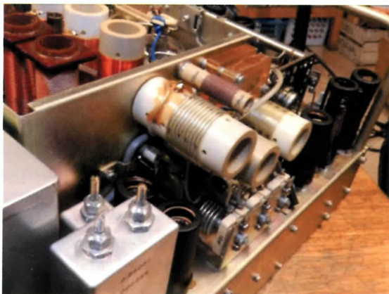
Detail van een originele 3030 in bezit van Menno Putman. De koppellus op de tankkring voor de hoge band is goed zichtbaar.
