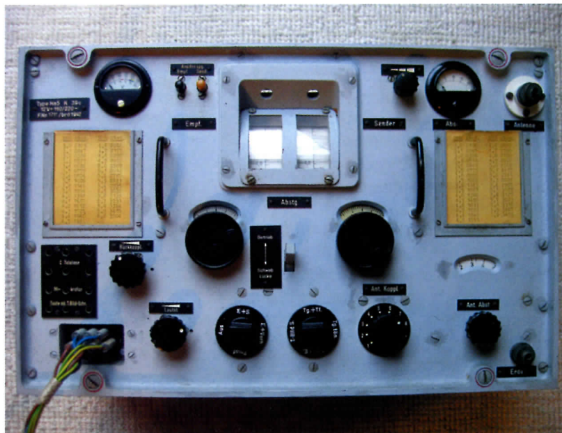
Foto 1: Het 5-Watt-Sende-Empfangsgerät Ha5 K 39.
