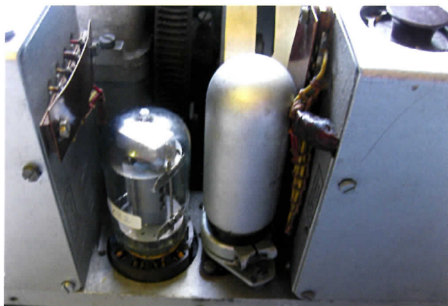
Foto 8: De PA-eindbuis RL12P10 (links) en de stabilisatorbuis (rechts) t.b.v. de schermroosterspanning van de zender-oscillator.
