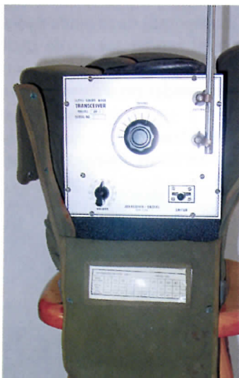
foto 1 De Jefferson-Travis VHF-tranceiver type UF-1 in de groene hoes, het glimmende front geeft het toestel niet direct een "militaire uitstraling"
