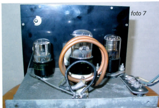
foto 7 De spoelen L1 (de zwarte lus) en L2. De koperen buis is de anodespoel waarin zich de roosterspoel bevindt.
