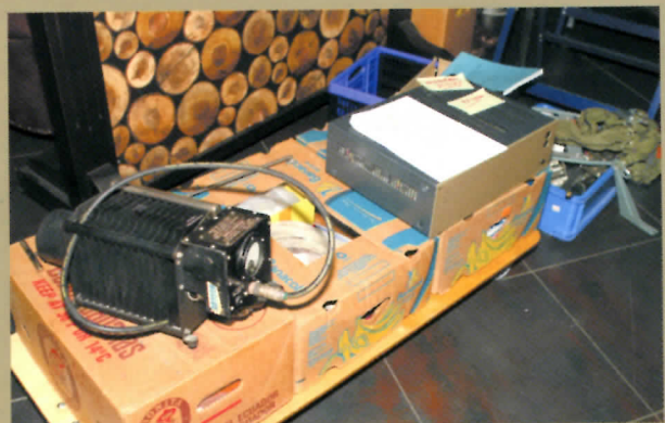
Fraaie VHF-vermogensmeter, helaas niet 50 Ohm en een ongunstig frequentiegebied (30 - 400 Mc/s)
