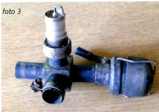
Foto 2 en 3: Kristalmixer met een CV101 diode in een speciale houder, gemonteerd op de rhumbatron
