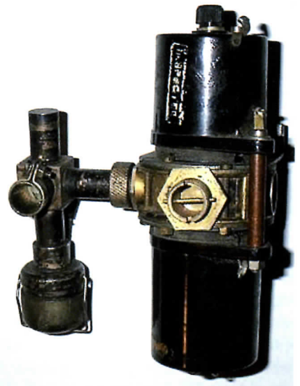
foto 10: Links de mixer die d.m.v. een flens gemonteerd is op de TR-cell CV43
