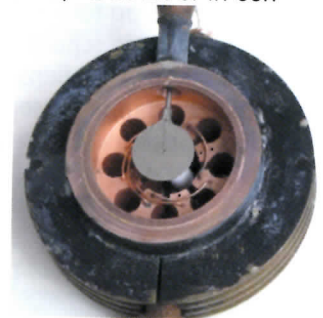
foto 7: De trillholtes (in feite de afgestemde kringen) van het magnetron, de strapping is duidelijk te zien
