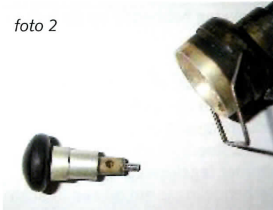
Foto 2 en 3: Kristalmixer met een CV101 diode in een speciale houder, gemonteerd op de rhumbatron
