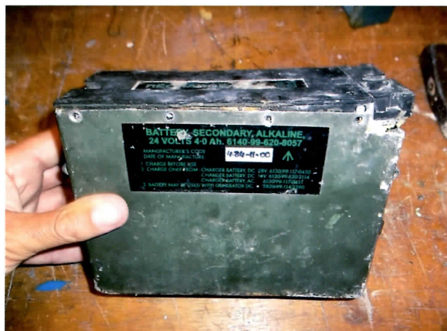
foto 3 De batterij-behuizing met de oude NiCd-cellen
