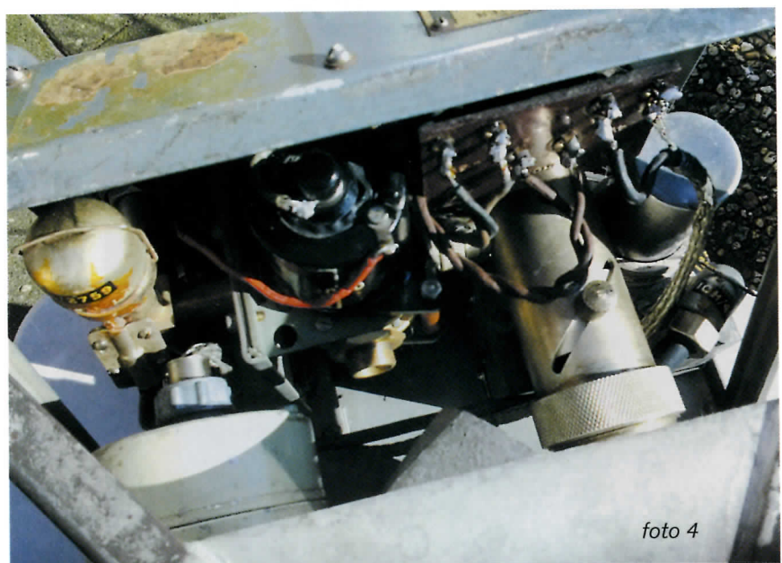
Linksboven de kristalmixer, het zwarte object in het midden is het rhumbatron
