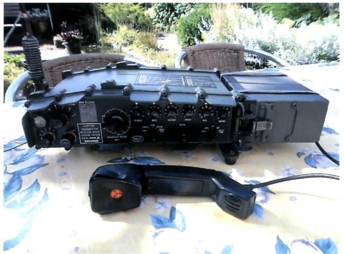
Foto-7 De PRC-320 met de nieuwe batterijbehuizing
