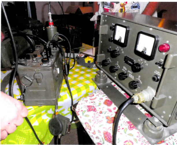
Foto 6. Voor de voeding van de setjes had Wim een universele voeding van de KL meegenomen.
