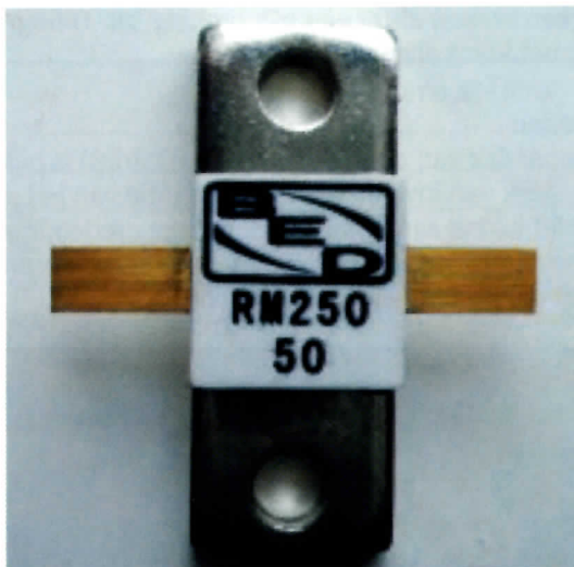
Foto 1. Keramische 50 Ohm inductievrije weerstand, moet wel op een koelplaat worden gemonteerd.
