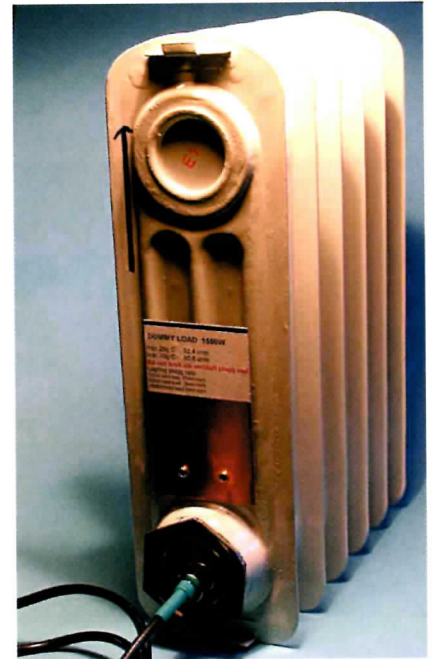
Foto 8. 50 Ohm dummyload voor groot vermogen (1,5 kW), lijkt net een radiatorkachel, maar dat is hij in feite ook.
