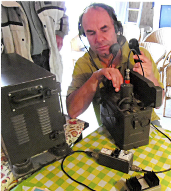
Foto 7. Controleren of de zender vermogen aan de dummy afgeeft.
