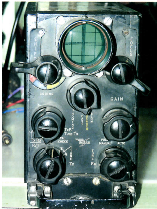
Foto 2. Vooraanzicht van de SARAH-set. De keuzeschakelaar (met de 4 gekleurde vlakken) voor de 4 verschillende types baken/noodzender is goed zichtbaar.
