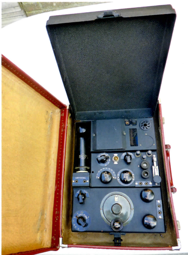
Foto 2: De MR 3, onderin de ontvanger, in het midden de zender en bovenin de voeding. Geheel links de 6L6 van de oscillator/PA.
