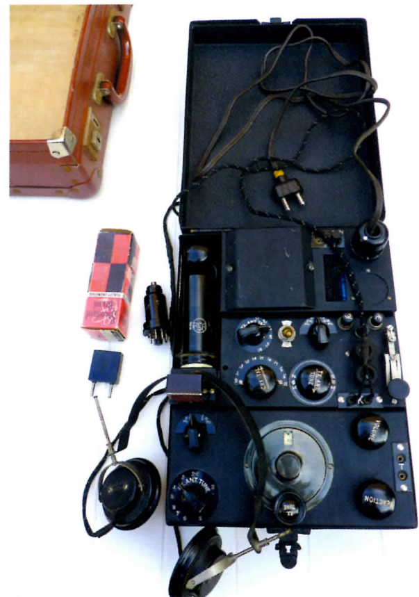
Foto 3: Uit de koffer met ingestoken kristal (onder de 6L6). De seinsleutel kan niet van de set worden afgenomen zoals bij de B 2, maar hier kan een externe seinsleutel worden aangesloten.
