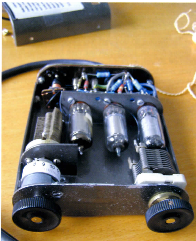
Foto 12: De nagemaakte Sweetheart met afgenomen deksel. Links de afstemknop, rechts de instelling van de terugkoppeling.
