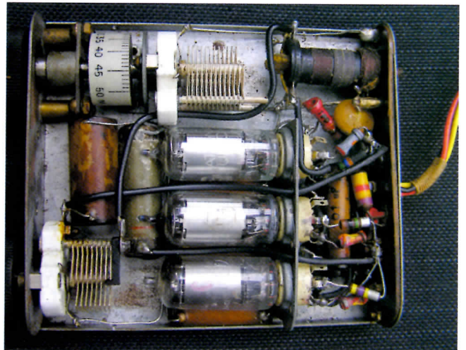
Foto 8: De originele Sweetheart met afgenomen deksel. Duidelijk is te zien dat er niet veel onderdelen in zitten.
