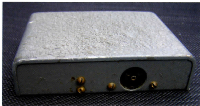
Foto 3: De originele battery box met gesloten deksel.
