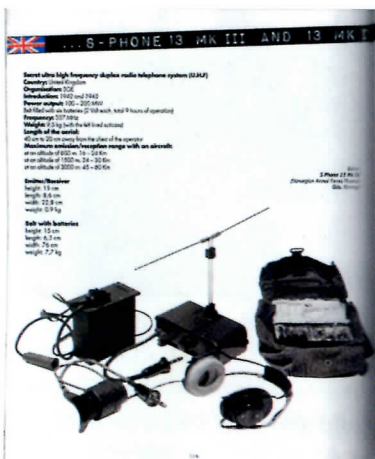
Foto 4: De op de man gedragen S-phone installatie.
