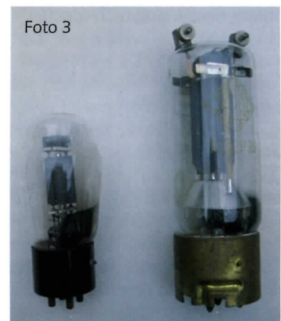
Foto 3: Links de triode RL12T15, rechts de penthode RL12P35, de veel toegepaste eindbuis in apparatuur van de Wehrmacht, bruikbaar tot 65 MHz..
