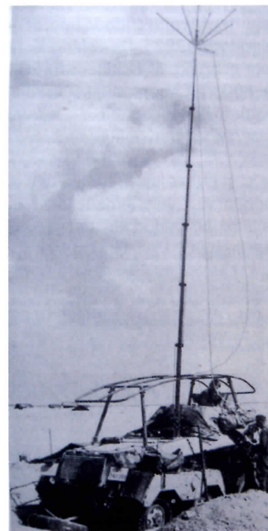
Foto 11: Een verkenningswagen met opgerichte Kurbelmast, met deze antennemast konden grotere afstanden worden overbrugd dan met de dakantenne. De antenne zelf is de verticale draad (in een bocht hangend), de andere lijn dient voor het uitvouwen van de toploading.
