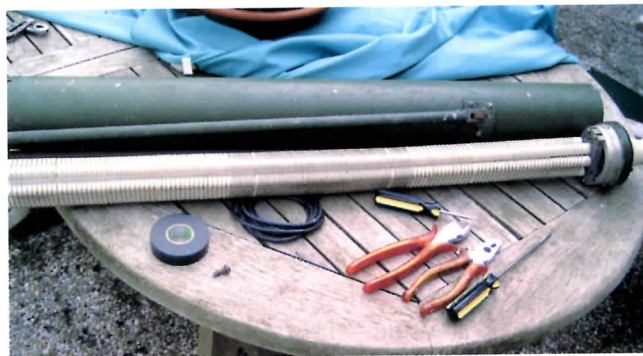
Foto 6: Het inwendige van de afsluitweerstand (lopende golfweerstand). Het geheel heeft een distributieve Ohmse weerstand van 40 – 45 Ohm. Hij heeft natuurlijk ook zelfinductie en door de opsluiting in de buis is er ook een verdeelde capaciteit. Het lijkt een vlakke hoogohmige weerstand van 600 Ohm en hij kan gezien de afmetingen, wel wat dissiperen.
