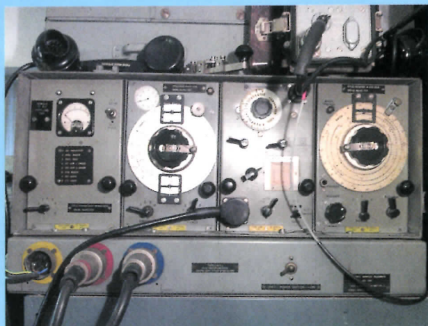
Restauratie van de Marconi CNY-2 transceiver
