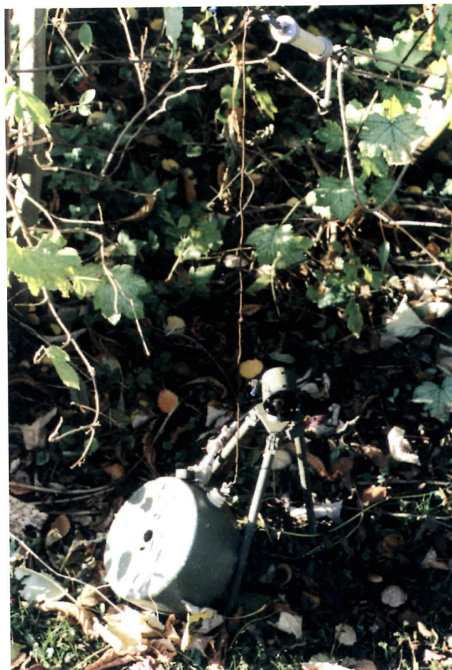
Foto 7: De ingangsbalun voor de halve ruitantenne, op de driepoot de kleine uitvoering voor ontvangst.
