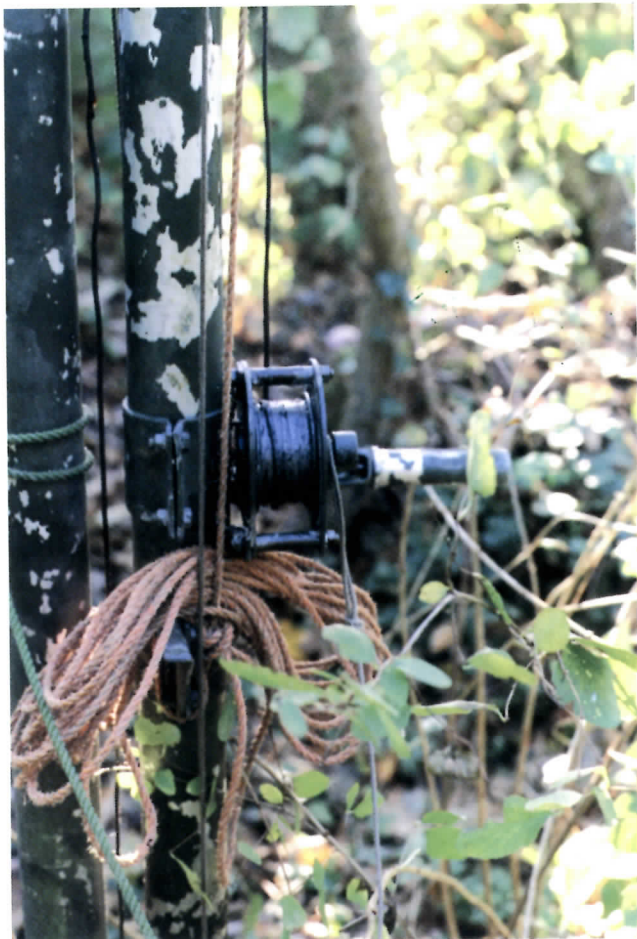
Foto 4: Het handliertje van de mast.
