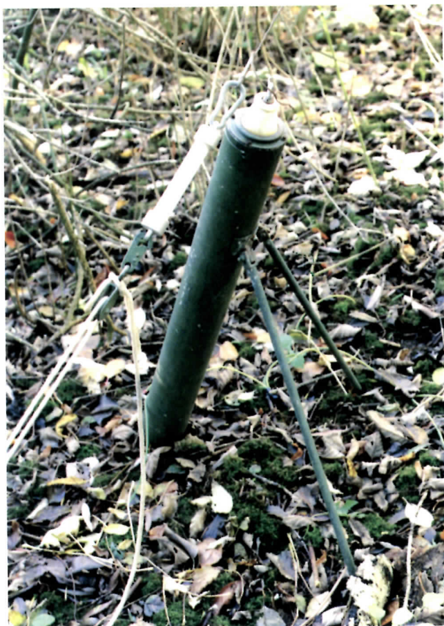
Foto 5: De dummyload-afsluitweerstand van de halve ruit-antenne.
