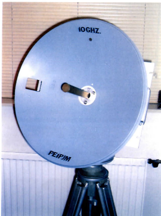
Voorzijde prime-focus schotel met belichter (10 GHz). De schotel is afkomstig uit een vliegtuig.
