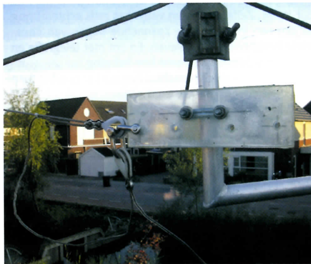
foto 2: Van een stuk plexiglas en wat 2-componentenlijm werd een stevige midden-isolator gemaakt.
