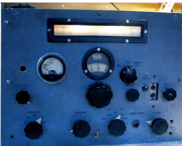
Foto 1: Het front van de ontvanger. Duidelijk zichtbaar zijn ook de Nederlandse opschriften. De teksten zijn in de dikke frontplaat ingeslagen en gelakt.
