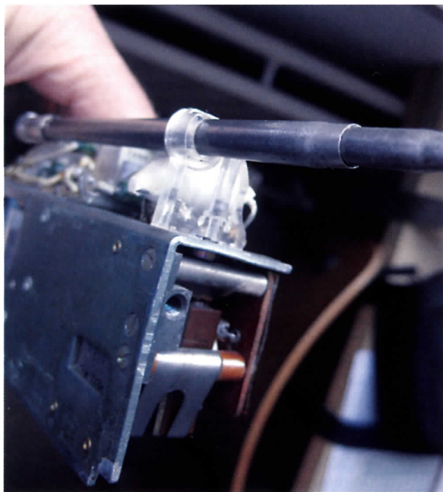
Foto 6: Het bovenste geleidepunt van de telescoopantenne. Dit kan gemakkelijk afbreken wanneer de antenne wat stroef in deze geleiding kan schuiven.
