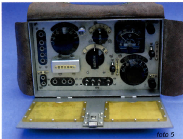
Foto 5: Zender van Frans, onder het aluminium klepje kan het zendkristal worden geplaatst (foto F. V.)
