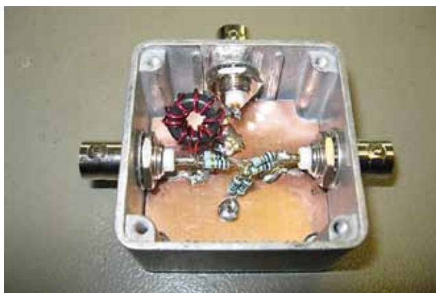
Foto 4: Zelfgebouwde Return-Loss Bridge.
