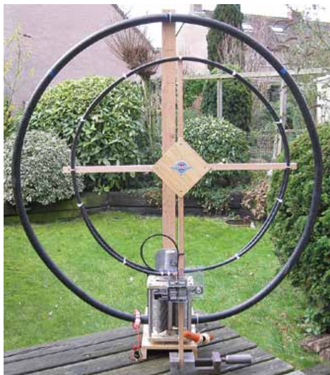
Foto 6: Foto met zijn grote broer (diameter 1 m) die geschikt is voor het zenden met 100 Watt.
