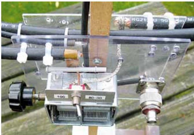
Foto 3: De koppellus heb ik tussen de 2 plaatjes met tiwrap's vastgezet aan de loop. Het andere eind is afgemonteerd op een PL-chassisdeel.
