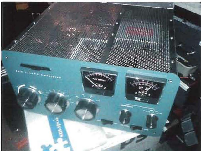
Foto 8: De tweede keer op het lichtnet, het testen van de hoogspanning, zie linksboven de gloeiende 3 - 500Z's.
