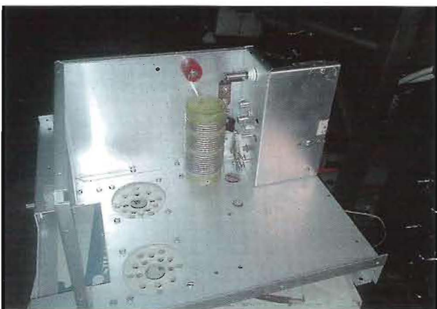
Foto 5: Het chassis met daarin de buisvoeten en de anodekring, rechtsboven de ingangskringen, boven de spoel het interlockcontact.
