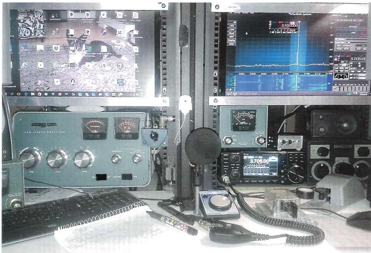
Foto 10: In bedrijf met de ICOM 7300 (rechts), er boven de displays van de Flex 6300, de ICOM 7300 is op dat moment afgestemd op de SRS-frequentie, de eindtrap leverde toen circa 400 Watt AM!. Het zwarte "ding" in het midden is de Heil microfoon van de Flex 6300.
