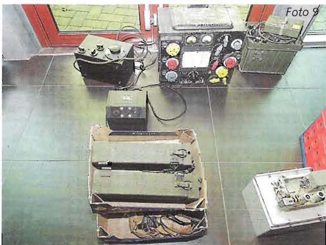
Foto 9: Links op de foto een zeldzame VHF rechtuit ontvanger, daarvoor staat de bijbehorende voeding
