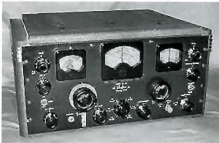
Afb 5 De amateur VHF radio-ontvanger S-27 waarmee het Duitse Knickebein werd ontdekt.
