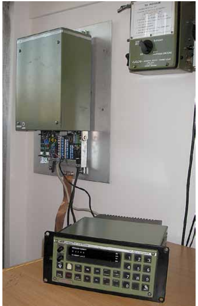
Foto 6: De SAILOR hier in de proefopstelling beschikt over 250 W uitgangsvermogen in alle modes op alle amateurbanden
