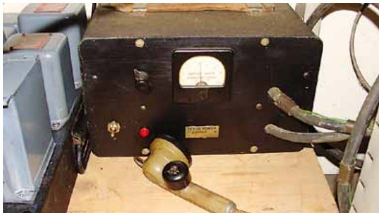
Foto 9: Mijn eigenbouw voeding van 8 kg voor het hele TCS met 600 V i.p.v. 450 V met de Collins voeding ernaast
