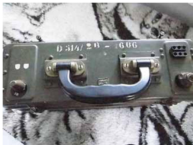
Foto 5: bovenkant met hengel, aansluiting telemicro, antenne en squelchknopje
