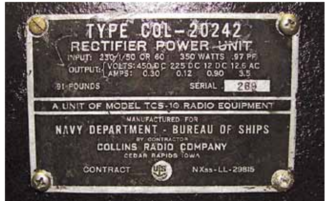
Foto 7: Benodigde standaard spanningen en vermogens
