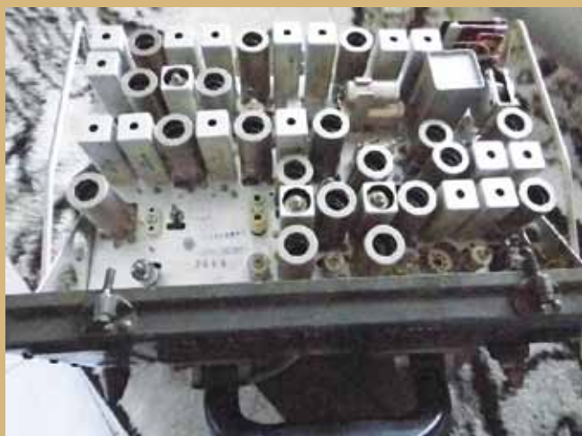
Foto 3: onderzijde chassis met zelfdragende onderdelen
