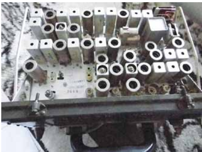
Foto 3: onderzijde chassis met zelfdragende onderdelen
