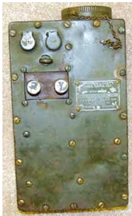
Foto 13: Extra (zeldzame) WW2 uitrusting voor bij de TCS de CACS-23398 phone patch
