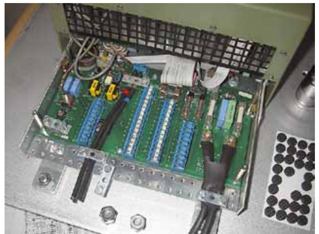
Foto 7: Het gedeelte van de T2130 waar alle aansluitingen gemaakt worden, twee coaxkabeltjes en een 'printerkabel' leiden naar de exciter RE2100
