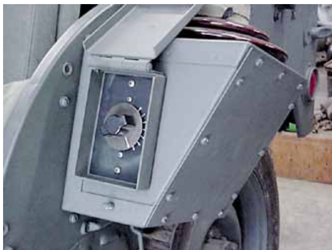
Foto 3: Jeep montage van de antenna loading coil
