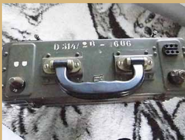
Foto 5: bovenkant met hengsel, aansluiting telemicro, antenne en squelchknopje
