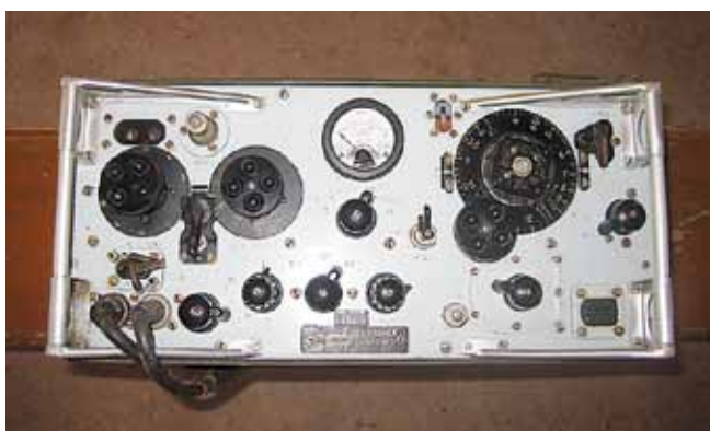
Foto 12: Behalve aan de blauwe kleur is aan het modificatieplaatje boven het typeplaatje te zien dat het hier om een marine-uitvoering van een WS62 gaat
