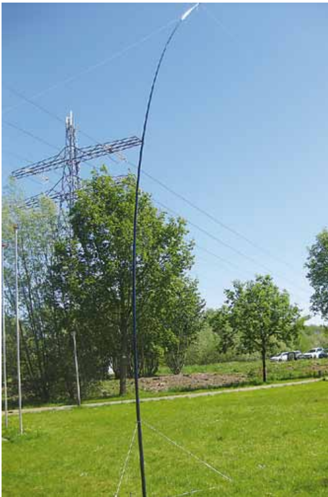
Foto 1: Het handige antennemastje van Hans, PE1ECO dat in delen uit elkaar kan worden genomen
