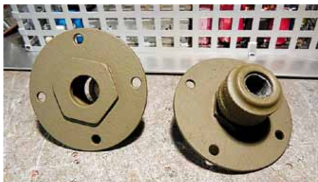
foto 16: schijven met wartels
