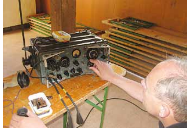
Foto 2: Wim Kramer, PA2GRC toont het thema van de dag: de WS62. Hier probeert hij een WS62 met kristalsturing af te stemmen
