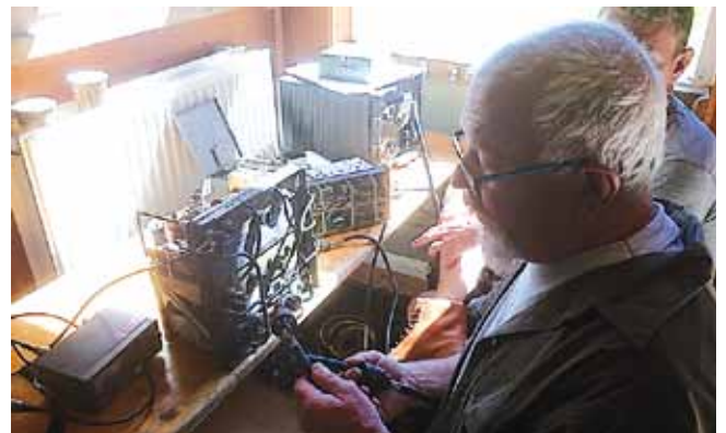
Foto 4: Ook een GRC/9 was aan de beurt, helaas zat de voedingskabel vol met sluitingen als gevolg van totaal uitgedroogde rubberen draadisolatie
