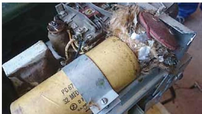
Foto 8: De uitgebouwde omhulling van de geëxplodeerde condensator van 32 uF uit de voeding van de WS19. Een nieuwe moderne C van 33 uF staat er naast en valt daarbij bijna in het niet
