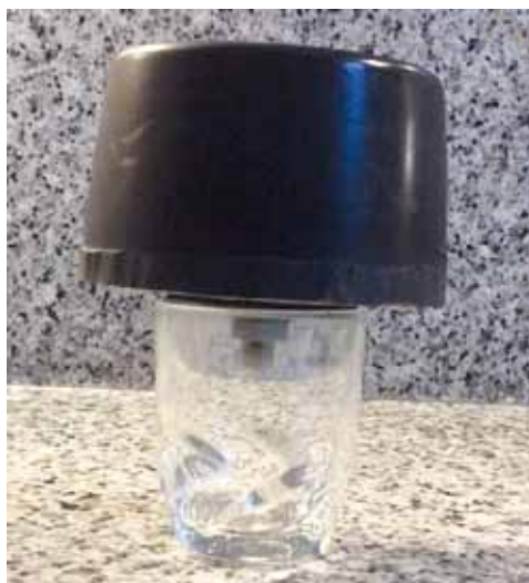
Foto 10 en 11: Hetzelfde, maar nu op 70 cm. Links de gesloten antenne op een borrelglaasje, rechts opengemaakt. Links zit de topcapaciteit, op resonantie gebracht met een stukje polystyreen in de lichtspleet. Kosten van deze antenne: € 2,50 op de radiomarkt in Rosmalen
