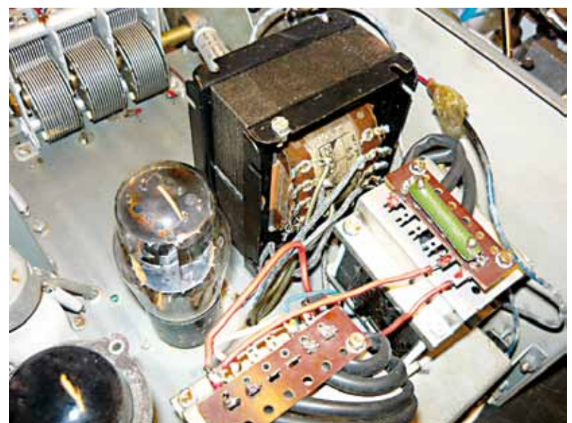
Foto 6: Nettransformator met de 5V4 gelijkrichtbuis
