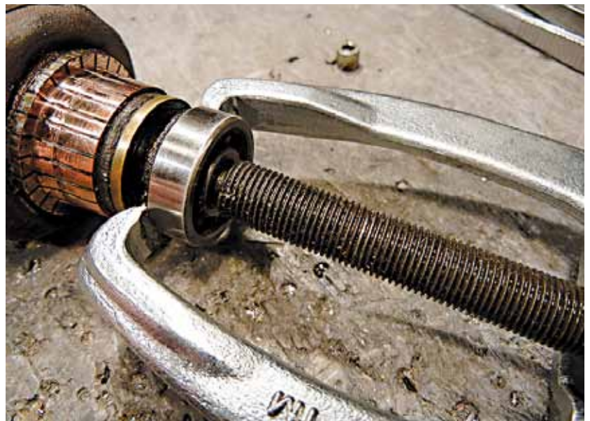
Foto 6: Pulley trekker, de haken heb ik zo ver weggeslepen dat ze een goede grip op de lagertjes hebben
