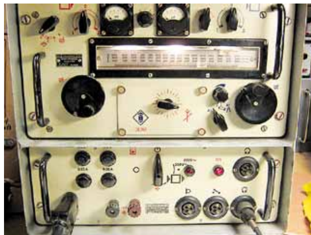
Foto 7: vooraanzicht, boven RTX onder voeding
