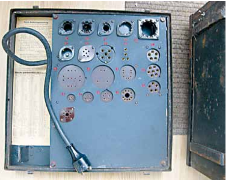
Foto 3: Het deksel met de buisvoeten voor Wehrmacht buizen, in het deksel zit een lijst met geplakt met types van de meeste Wehrmachtbuizen
