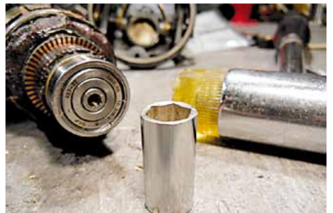
Foto 7 en 8: Bij het monteren gebruiken we een hulpstuk om de lagers op de as te tikken. Geef alleen tikjes op de binnerring en nooit op de buitenring, gebruik als het kan een plastic hamer of anders een stukje hout om beschadiging te voorkomen
