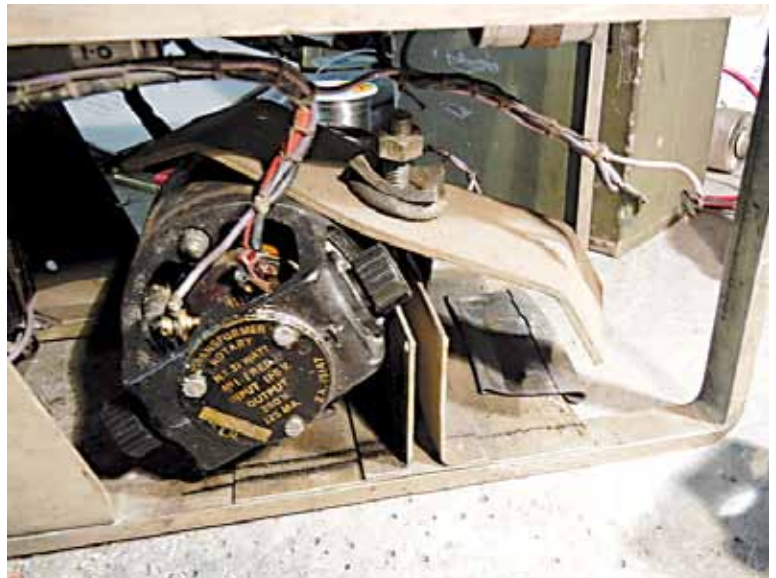
Foto 2: Dynamotor van de zender geheel verwijderd
