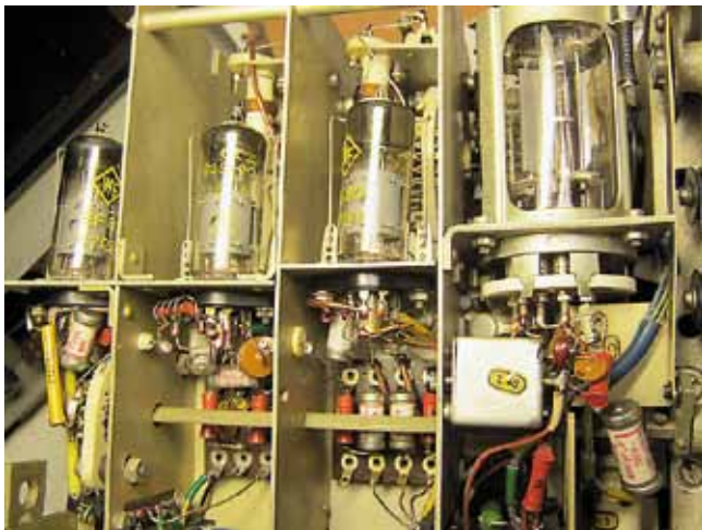
Foto 1: oscillator-buffer-vermenigvuldiger en eindtrap
