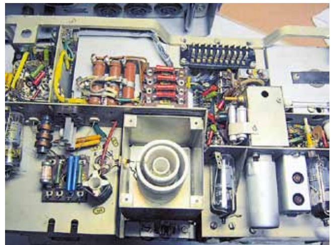
Foto 4: compartiment met concentrische keramische VFO-spoelen
