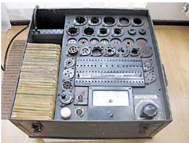
Foto 2: De RPG 4/3 met de bak met testkaarten. Rechts onder de functieschakelaar met 14 standen. De witte knop met rechts daarvan het voetje voor D-buisjes is een latere niet originele modificatie
