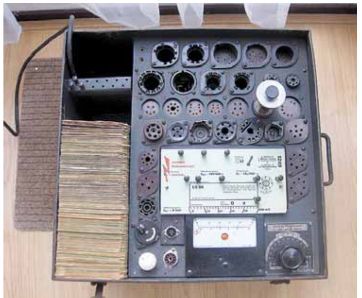
Foto 4: Een buis type LS50 tijdens test, de neonlamp geeft aan dat er hoogspanning aanwezig is
