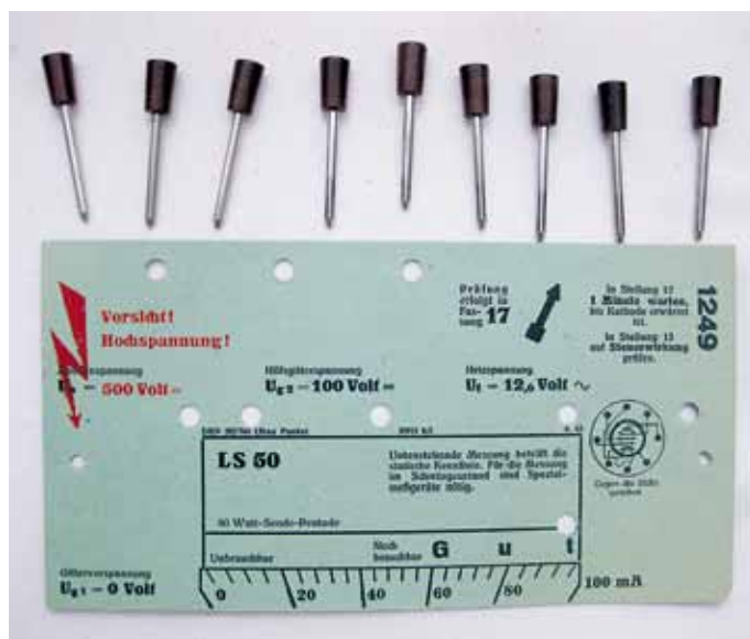
Foto 8: De kaart voor de LS50 met de benodigde testpennen
