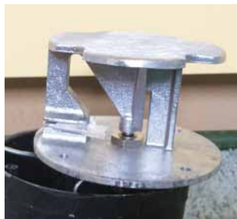
Foto 10 en 11: Hetzelfde, maar nu op 70 cm. Links de gesloten antenne op een borrelglaasje, rechts opengemaakt. Links zit de topcapaciteit, op resonantie gebracht met een stukje polystyreen in de lichtspleet. Kosten van deze antenne: € 2,50 op de radiomarkt in Rosmalen
