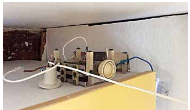
Foto 6: De LC parallelkring, hiermee zet je de antenne op de juiste frequentie
