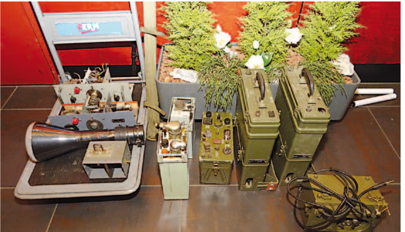
Foto 14: In het midden een WS38AFV met de bijbehorende originele 12 V trillervoeding. Links op de kar enkele WS17's zonder (houten) kast.
