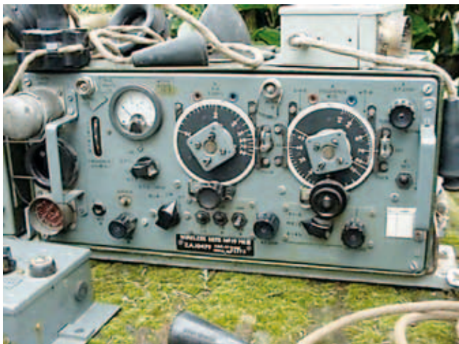
Foto 1: Een Britse Wireless set No.19 MkIII in volle glorie. Op mounting compleet met control boxen en toebehoren.
