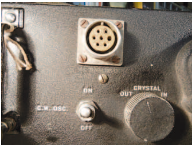
Foto 2: Een bijzondere plug op het front, mis waarschijnlijk toch origineel
