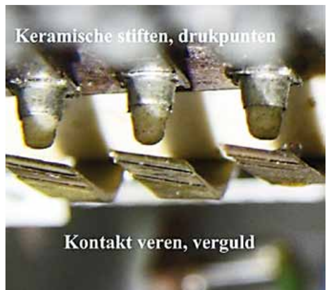
Foto 1: contacteren in spoeltrommel.
