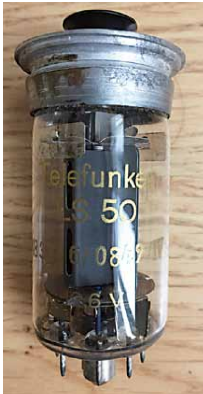
Foto 2: De LS50, een veel gebruikt HF-werkpaard in Duitse militaire radio-apparatuur uit WOII
